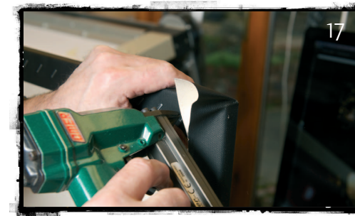
Obr. 17 • Vždy postupujte od středů k rohům a neustále kontrolujte kvalitu napnutí.
