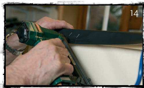
Obr. 14,15,16 • Zajišťujte plátno pomocí sponkovací pistole od středu plátna k jeho rohům. Dbejte, aby sponky měly sklon 45 stupňů. Při napínání pracujte s kleštěmi pro přesné a rovnoměrné obepnutí plátna přes profil.
