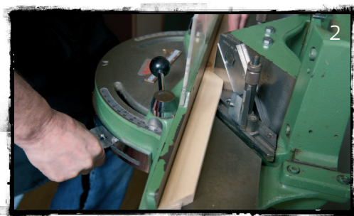
Obr. 1, 2, 3 • Nastavte sekačku na požadovaný rozměr. Usekněte napínací rám, který bude odpovídat velikosti plátna, které chcete napínat. Můžete použít i pilu namísto sekačky.
