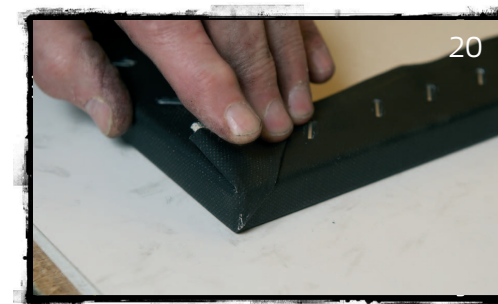
>> položte plátno dílem na stůl. Založte jeden okraj plátna a přispoukajte. Potom založte druhý okraj plátna a taktéž zajištěte sponkou. Toto opakujte pro všechny čtyři rohy.
