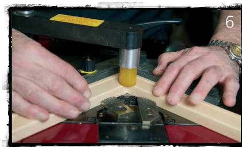
Obr. 5,6 • Nastavte sponkovačku pro spojení rámu. Rovnoměrně rozmístěte sponky pro přesné a pevné spojení rámu.
