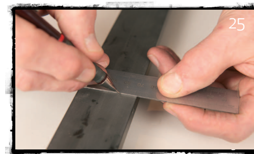
Obr. 25,26,27 • Na zadní straně rámu narysujte značky pro vyvrtání otvorů pro šrouby, které budou zajišťovat plátno v rámu. Nakreslete si rám v řezu, abyste si byli jistí správnou pozicí vrutu.
