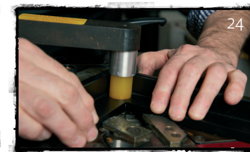
Obr. 23,24 • Sesponkujte ramena pomocí sponkovačky. Dbejte na rovnoměrné rozmístění sponek, dostatečné nanesení lepidla a eventuální začástení spoje.
