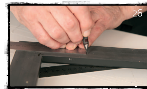
Obr. 25,26,27 • Na zadní straně rámu narysujte značky pro vyvrtání otvorů pro šrouby, které budou zajišťovat plátno v rámu. Nakreslete si rám v řezu, abyste si byli jistí správnou pozicí vrutu.
