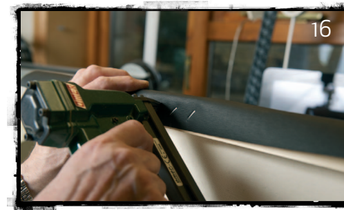
Obr. 17 • Vždy postupujte od středů k rohům a neustále kontrolujte kvalitu napnutí.
