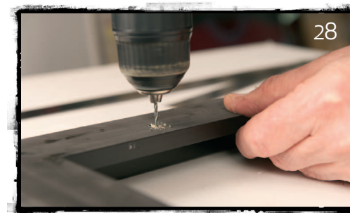
Obr. 28,29 • Použitím ruční vrtačky vyvrtajte díry pro šrouby. Šrouby lehce zapusťte do lišty.
