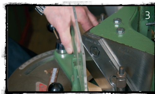
Obr. 1, 2, 3 • Nastavte sekačku na požadovaný rozměr. Usekněte napínací rám, který bude odpovídat velikosti plátna, které chcete napínat. Můžete použít i pilu namísto sekačky.
