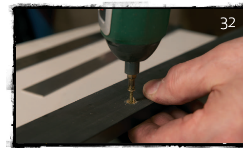
Obr. 32,33 • Zajištěte pomocí šroubů. Poté vyjměte polystyrenové pásky.
