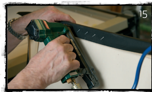
Obr. 14,15,16 • Zajišťujte plátno pomocí sponkovací pistole od středu plátna k jeho rohům. Dbejte, aby sponky měly sklon 45 stupňů. Při napínání pracujte s kleštěmi pro přesné a rovnoměrné obepnutí plátna přes profil.
