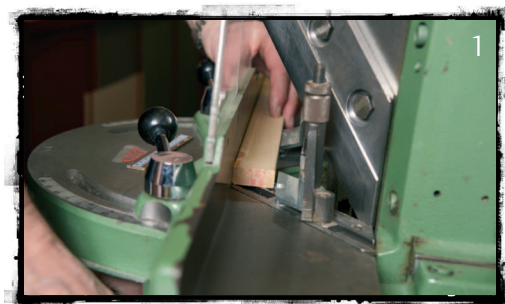
Obr. 1, 2, 3 • Nastavte sekačku na požadovaný rozměr. Usekněte napínací rám, který bude odpovídat velikosti plátna, které chcete napínat. Můžete použít i pilu namísto sekačky.
