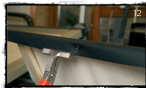
Obr. 11,12,13 • Začněte na středě každého ramene, poté na protilehlém konci a to na všech čtyřech ramenech. Buďte opatrní, aby vám značky na plátně i napínacím rámu na sobě vždy seděly.
